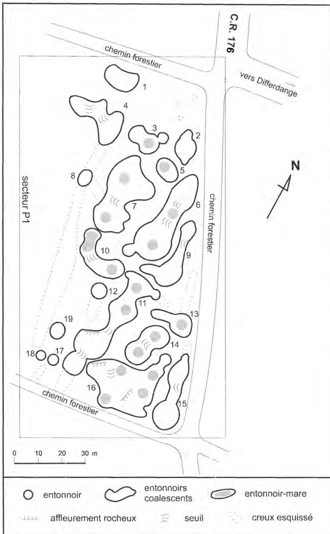
Figure 53: La localisation des creux de subsidence du site Pellestack
