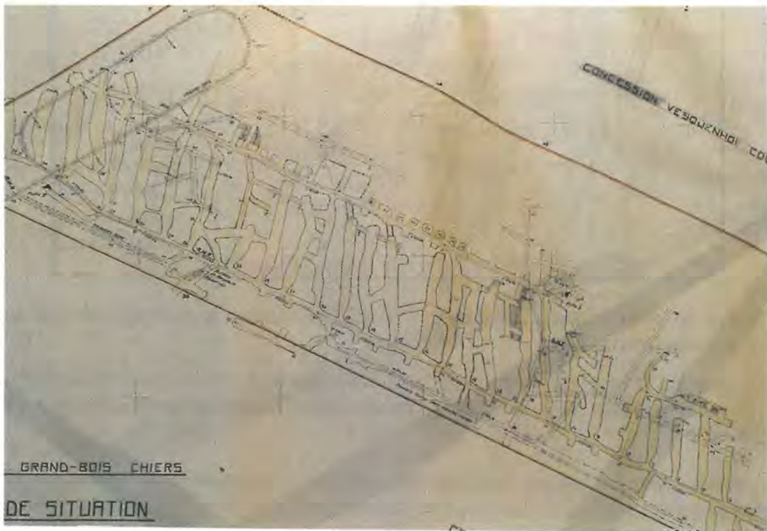
Figure 15: Traçage irrégulier des chantiers dans la mine Grand Bois de la Chiers du bassin de Differdange 5
