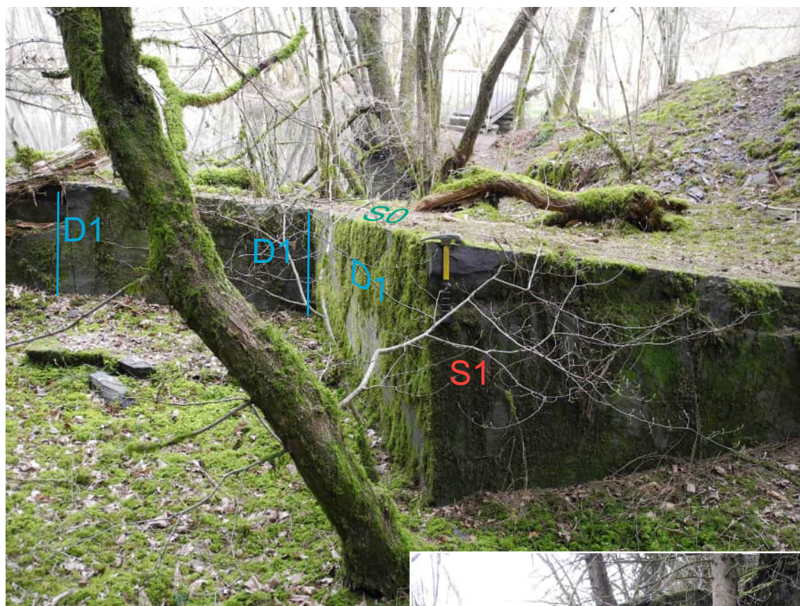
Photo 22 : Bilsdorf, point E409. Zone d'exploitation de l'ancienne carrière située à Neimillen. La photo prise vers le nord date du 29 mars 2022 (la Sûre se devine à la partie supérieure de la photo). Le plan de stratification (S0) est parallèle à la pointe du marteau. Le manche du marteau repose sur le plan de schistosité (S1). Immédiatement à gauche du marteau, le plan quasi vertical et fortement couvert de mousses correspond à un plan de diaclase (D1). L'intersection d'un autre plan de diaclase sur le plan de schistosité est soulignée par la ligne bleue D1 à gauche du tronc d'arbre incliné situé à l'avant-plan.
