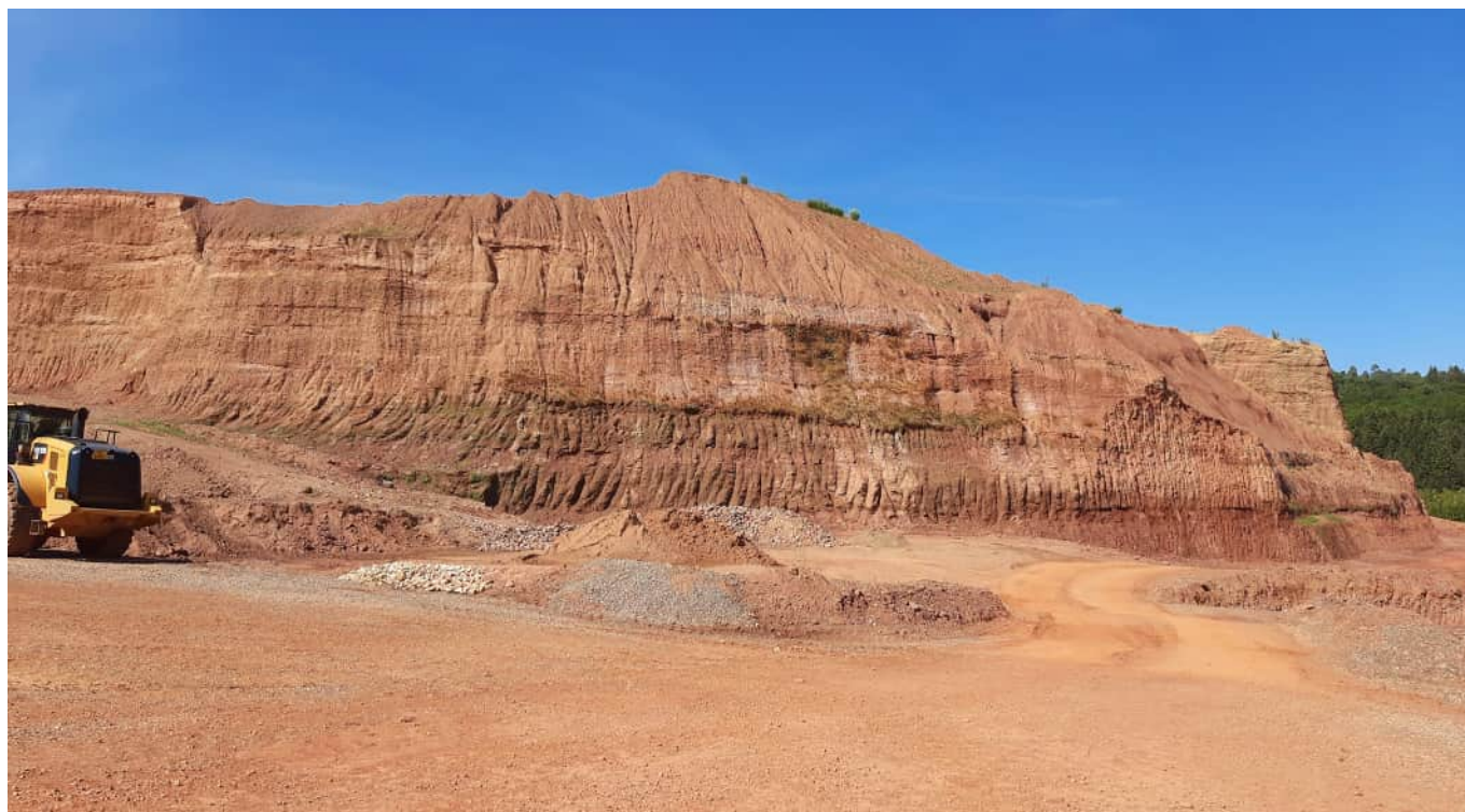
Photo 13 : Pratz, carrière Feidt - Folschette au lieu-dit ledert, point E332. Coupe dans la carrière montrant la totalité exploitée du conglomérat du Buntsandstein (situation 2022 : une trentaine de mètres d'épaisseur). Photo : Paul Wertz, 2022.
